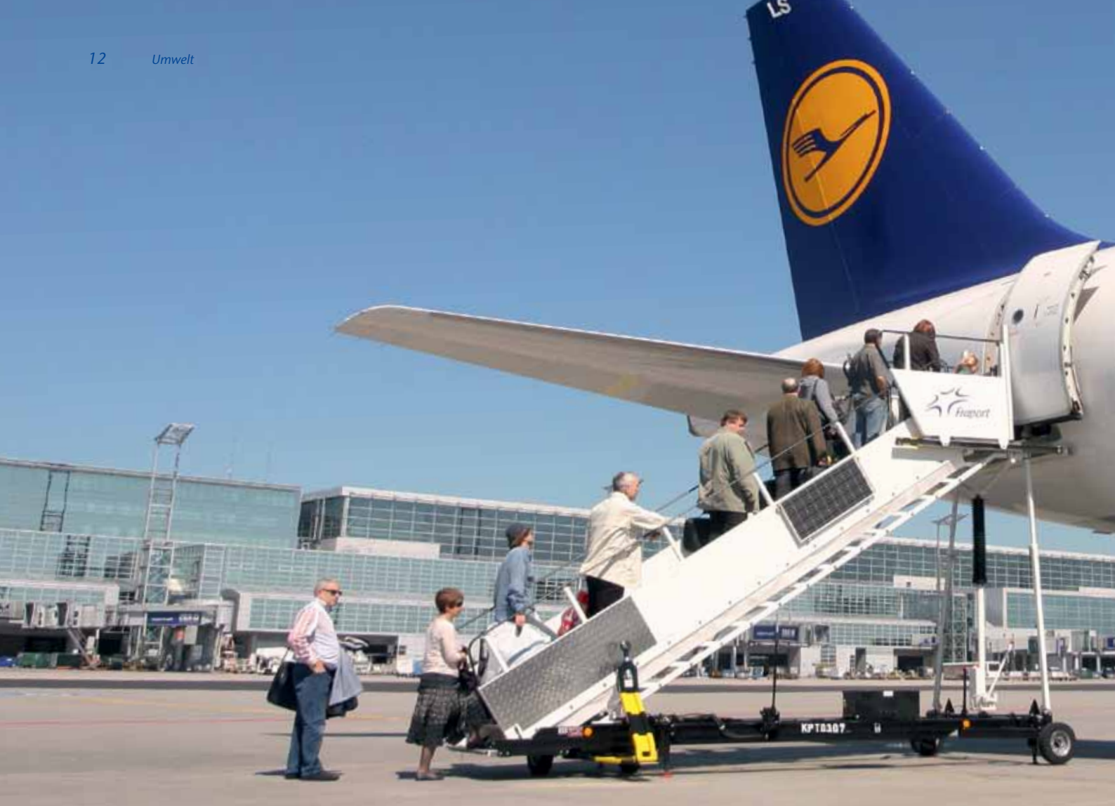
Bei vielen Passagiertreppen am Flughafen Frankfurt erzeugen Solarzellen die Energie für die LED-Beleuchtung der Stufen.
